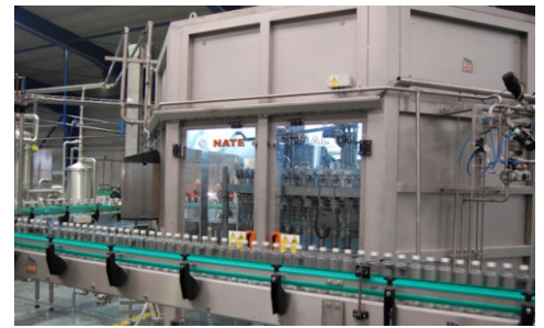
Füllvorrichtung mit Überdeckung VERAL 64 PEPSICO, Vitaco Impex s.r.l. Covasna, Rumänien
