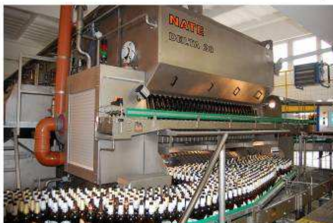
Myčka vratných lahví v provozu v pivovaru Ostravar
