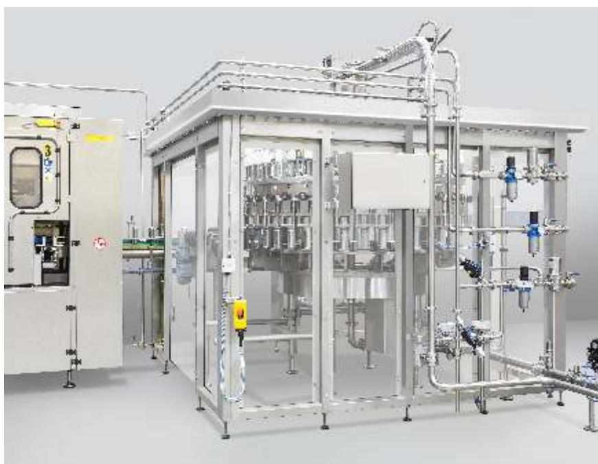
Вся система приводов машины основана на децентрализованных сервоприводах SEW Moviaxis с электронной синхронизацией. Это позволяет устанавливать версию рамы без стола, обеспечивающую отличные возможности чистки всех поверхностей, представленных в минимальном количестве и оборудованных под наклоном, а также удобный доступ к отдельным частям машины в процессе технического обслуживания.
