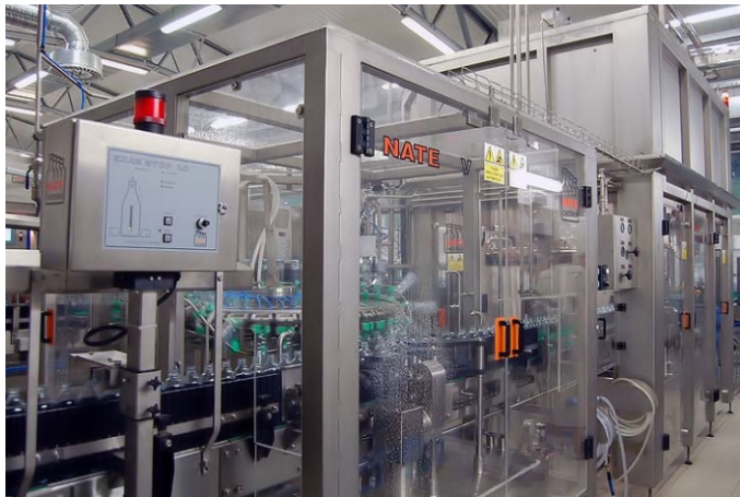
Разливочная машина после закрытия кожухами, Pepsico, Toma Teplice nad Metují, Чешская республика
